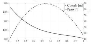
Fig. 6. Distribuciones radiales de cuerda y paso para la hélice optimizada por consumo energético.
