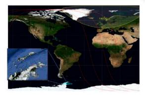
Fig. 7. Trayectoria de FACSAT-1 respecto a la Estación Terrena temporal en la Base General Bernardo O'Higgins. Fuente: adaptación de los autores con base en imágenes de Google Earth y Gpredict
