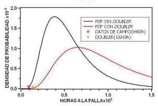
Fig. 4 Función de probabilidad de densidad de modelo con doubler.
