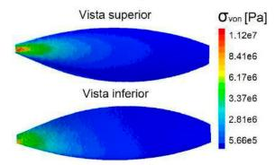
Fig. 4. Esfuerzo de von Mises calculado por FEA en CatiaV5 despreciando la fuerza centrífuga.
