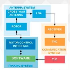
Fig. 4. Diagrama de bloques estación terrena. Fuente: CITAE
