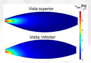
Fig. 3. Esfuerzo de von Mises calculado por la metodología propuesta despreciando la fuerza centrífuga.
