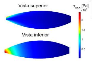
Fig. 5. Esfuerzo de von Mises calculado por la metodología propuesta teniendo en cuenta el aporte de la fuerza centrífuga.
