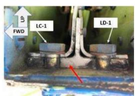
Fig. 1 a) Unión entre larguero y fuselaje y b) Registro fotográfico de accidente.
